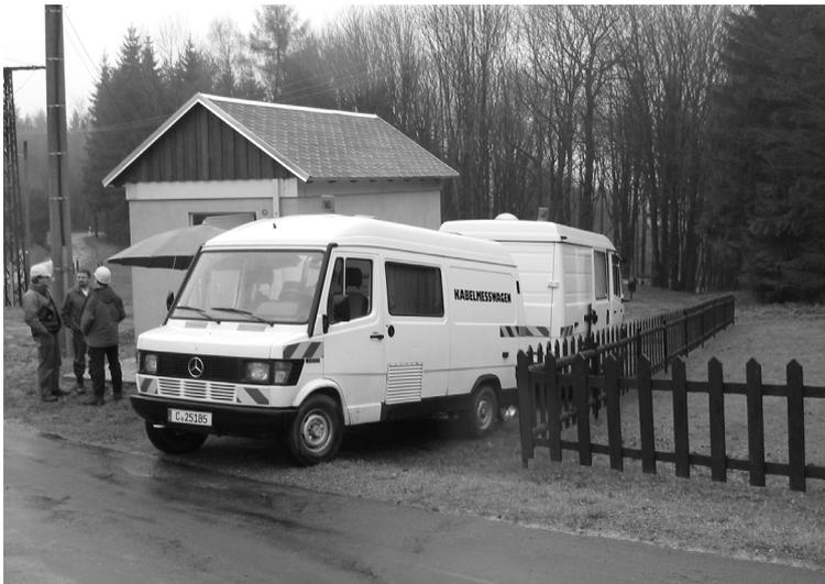
Leistungsstarkes Vor-Ort-Prüfsystem auf der Basis einer frequenzabgestimmten Resonanzprüfanlage kombiniert mit modernster Diagnose-technik, eingebaut in zwei Kleintransporter, Mit dieser Anlage können Mittelspannungskabel, aber auch andere kapazitive Prüfobjekte zur Zustandsbewertung geprüft und diagnostiziert werden.
