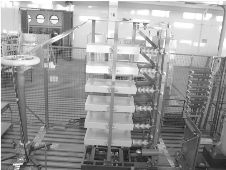
Stoßspannungsgenerator zur Erzeugung von Blitzstoß- und Schaltstoßspannungen bis 600 kV mit modernisierter Computersteuerung, Durchführung von Praktika zum Thema Stoßspannung und Untersuchung des Einflusses der Elemente des Stoßkreises auf den Spannungsverlauf
