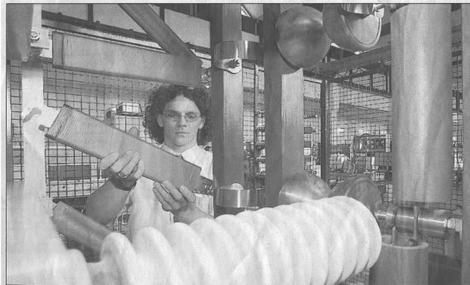
Klaus Mehlhorn bereitet den neuen Stoß-Spannungsgenerator in der Versuchshalle des Hochspannungs-Labors der Technischen Universität für einen Versuch vor.
