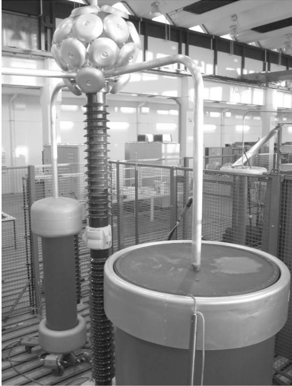
Leistungsstarkes Wechselspannungs-Prüfsystem bis 200 kV mit modernisierter Computersteuerung, geeignet z.B. für die Durchführung des FGH-Stufentest an Kabelproben, Dieses wird auch für diverse Prüfungsaufgaben von regional ansässigen Unternehmen genutzt.
